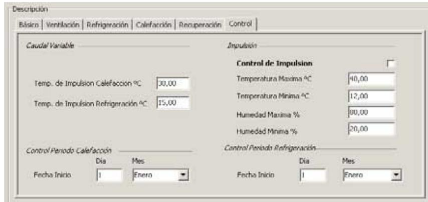
El régimen de funcionamiento de esta climatizadora viene fijado según un periodo fijado por el usuario. De ahí que se le pida la fecha de inicio de calefacción y refrigeración, para que la máquina impulse el caudal de aire de impulsión definido por el usuario en la pestaña de ventilación, a la temperatura de impulsión que se escriba en esta misma pestaña para cada uno de los regímenes.
