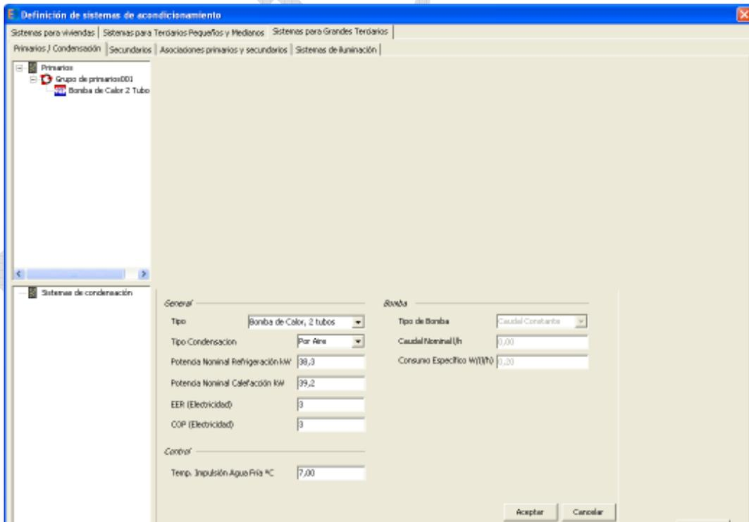
Dado que la bomba de calor está condensada por aire, no es necesario definir sistemas de condensación.
