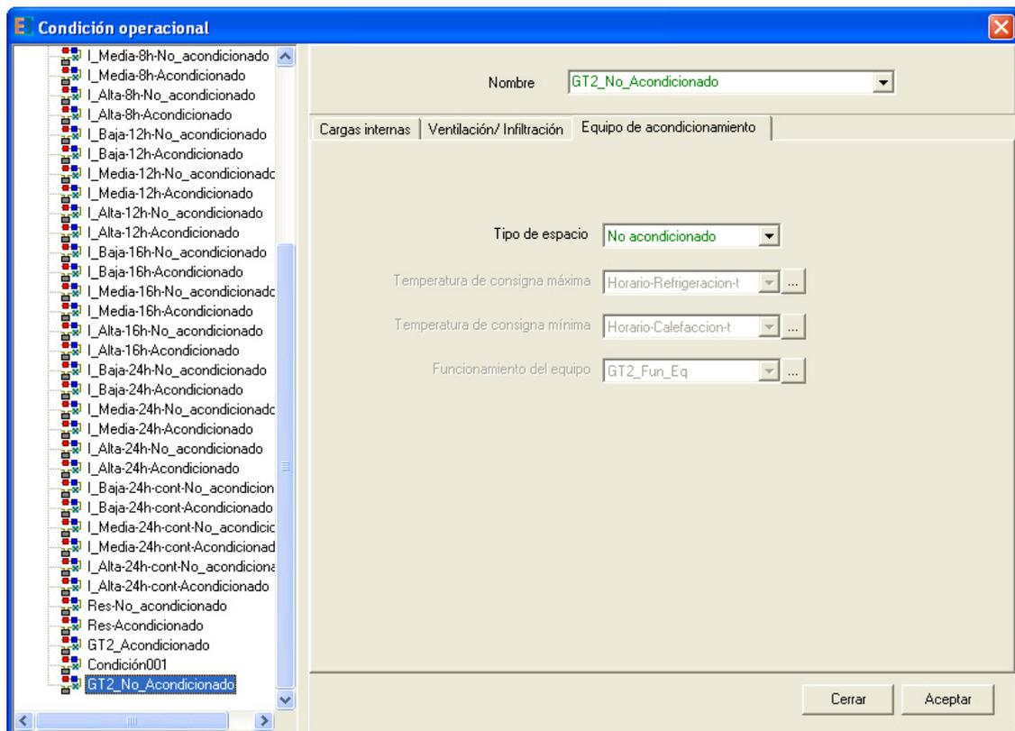
Para generar la condición operacional GT2\_no acond, simplemente se debe modificar de la COF GT2, el Tipo de espacio a No acondicionado de la lengüeta Equipo de acondicionamiento y guardar la condición con el nombre correspondiente.
