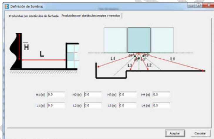
Se indicarán valores para las dimensiones H y L, según indica la figura adjunta, para caracterizar el efecto de sombras producidas sobre el edificio por obstáculos próximos o remotos.
