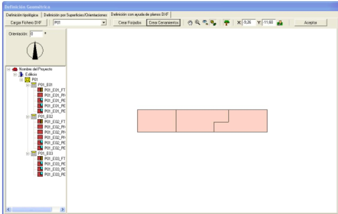
Se debe comprobar que la composición de cada cerramiento coincide con la deseada, pulsando con el botón derecho del ratón en cada cerramiento creado. Las fachadas Norte y Sur se encuentran compuestas por un 33% de la superficie por hueco.
